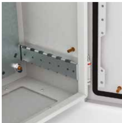
Kabelhalterung, Erstellen einer Innenstruktur und Tiefen-einstellung in 25 mm Stufen durch Universal-Stege (mit vorderseitiger Montage an den Universal-Montagebügeln).
