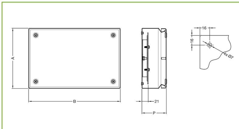
**Einfache Handhabung und Sicherheit** durch das innovative Verschlusssystem des Deckels mit ausziehsicheren Schrauben mit 1/4 Drehung.
